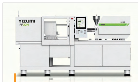
Cette presse de micro-injection est présentée dans une application de moulage de puces micro-fluidiques.
