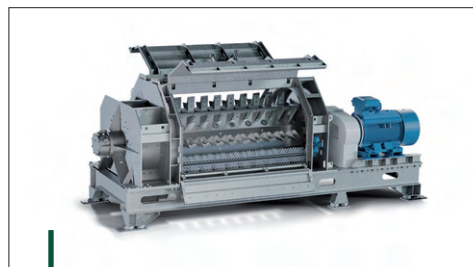
Le sécheur T 150-300 peut traiter de grands volumes de déchets plastiques.
