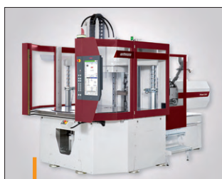
La table rotative à 2 colonnes offre une accessibilité optimale.
