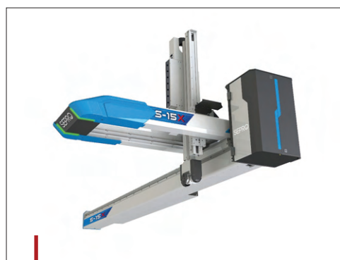
Les robots de la gamme S offrent des vitesses plus élevées, des courses plus longues et une charge utile plus importante.
