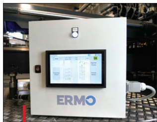
Le Mold-IQ : un outil intelligent de contrôle et optimisation des moules d'injection.
