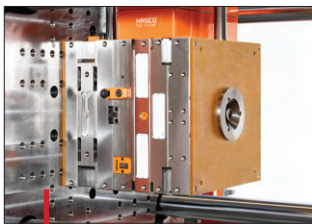
L'InsertKey permet d'identifier sans erreur les inserts de moules.
