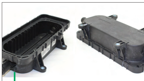
L'Amodel PPA Supreme est utilisé pour mouler ce boîtier et couvercle de chauffage HVCH de batteries. Il conserve ses propriétés mécaniques au-delà de 150°C.
