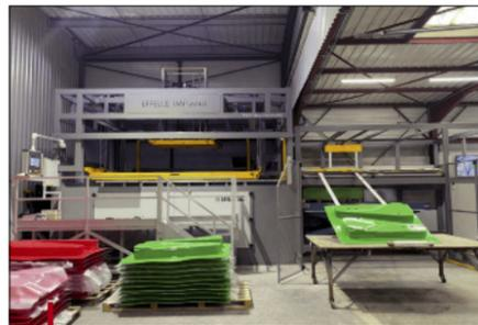
Agemo a également été équipé d'une nouvelle thermoformeuse capable de produire des pièces de grandes dimensions.
