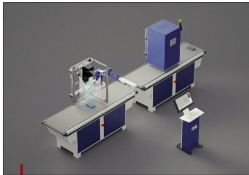
Le système PouchSTAR examine la forme, la taille et l'étanchéité des cellules des batteries lithium-ion et détecte de manière fiable les défauts de surface, la contamination et les dommages éventuels.
