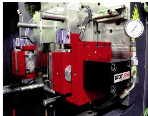
En exerçant des efforts sur le plan de joint, IronJaw augmente la force de fermeture appliquée au moule.
