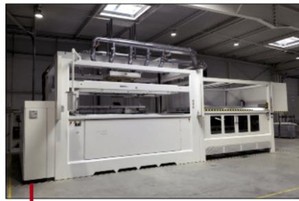
Cette thermoformeuse tout-électrique Geiss T10, installée chez Vercors, peut produire des pièces mesurant plus de jusqu'à 3,5 m de long.
