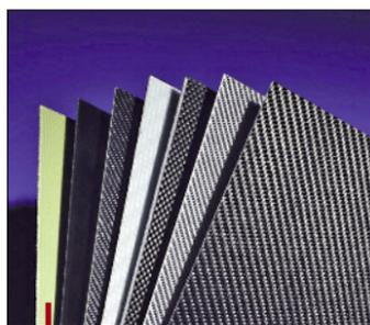
Les demi-produits composites thermoplastiques renforcés de fibres continues Tepex permettent de concevoir des pièces structurales légères.
