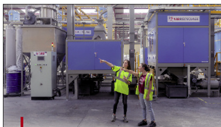
Le tri triboélectrique assure l'obtention de recyclés purifiés jusqu'à plus de 98% avant extrusion.
