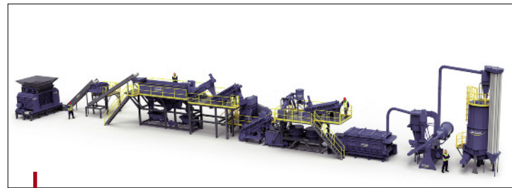
Schéma de principe d'une installation de lavage pour films post-consommation de Herbold Meckesheim.
