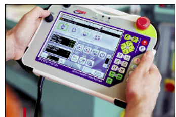
Grâce aux différents modules de commande STEC, les robots Star sont particulièrement faciles à programmer.
