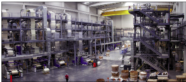
Une dizaine de lignes de coextrusion 3 couches (majoritairement Hosokawa Alpine) permettent de produire des films intégrant un fort taux de recyclé.
