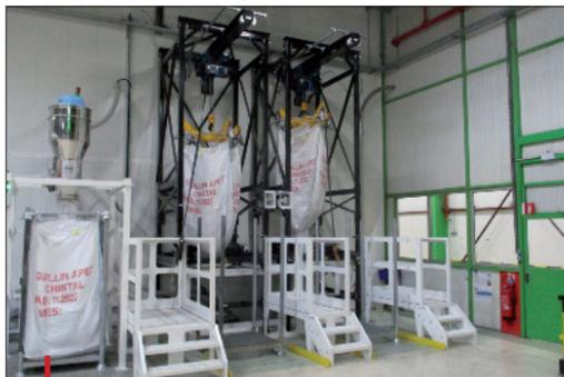
Station double vide big-bags (récupération des squelettes broyés de thermoformeuses). Envoi vers les lignes d'extrusion et mise en silos de l'excédent pour le week-end.
