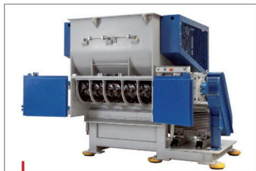
Un modèle très apprécié des recycleurs : le déchiqueteur Zerma ZIS 1500 et ses 90 kW de puissance.
