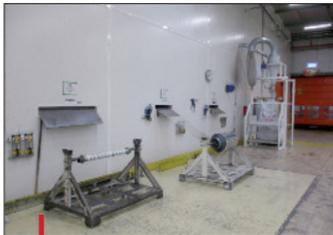
Broyage des bobines extrudées non conformes. Alimentation depuis l'extérieur du local.
