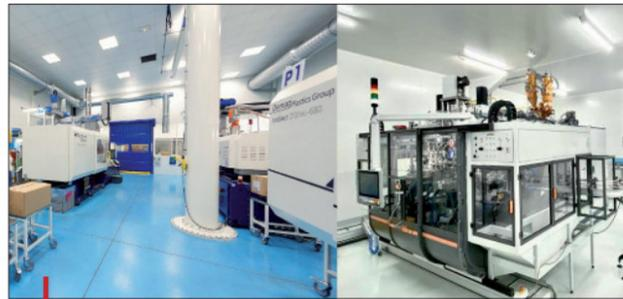
Deux salles blanches équivalentes ISO 7 abritent 8 presses Sumitomo-Demag tout-électriques et une machine de soufflage.
