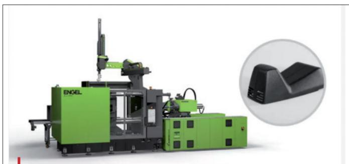
Une presse à 2 plateaux DUO 1480/500 t moulera sur le stand des capotages automobiles en PP recyclé.
