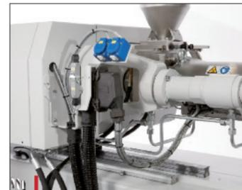
Le nouveau connecteur monté sur l'unité d'injection facilite les opérations d'entretien.
