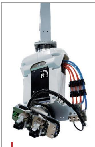
La nouvelle tête Servo permet de transformer un robot cartésien 3 axes en une machine à six axes.
