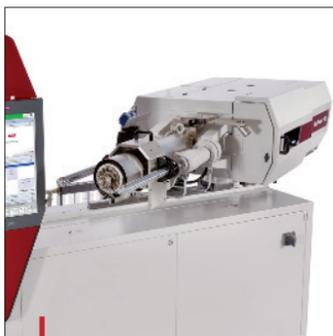
L'unité d'injection pivotante facilite les changements de fourreau.
