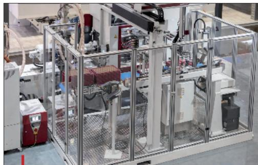
Sur le stand, une presse servo-hydraulique SmartPrimus 90/350 (ex-SmartPlus) sera intégrée dans une cellule de production de niveau à bulle en ABS entièrement conçue par le groupe Wittmann Battenfeld.
