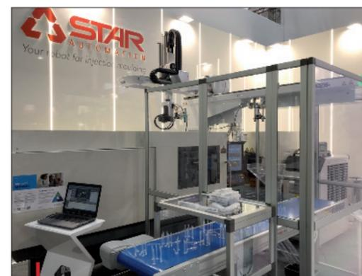
Cellule de production de seringues équipée d'un robot ZXW-1000VIP.
