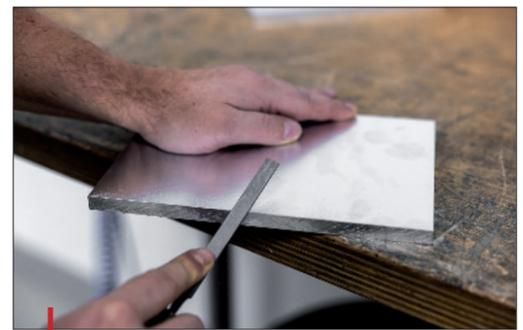
Préfabrication des ébauches : les trous pour les éjecteurs, les filetages et les ajustements pour un vissage ultérieur dans la carcasse de moule sont réalisés avant l'usinage des contours.
