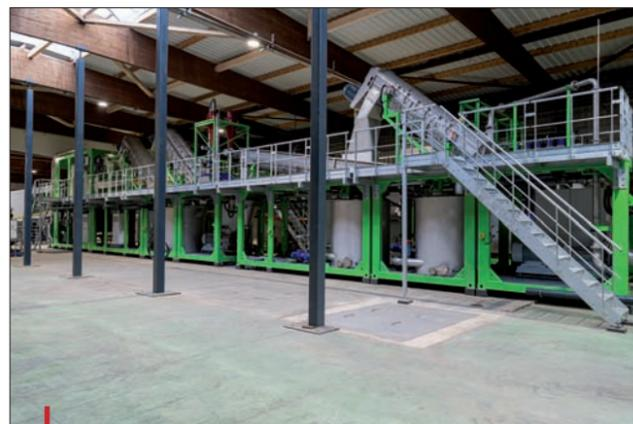
Les déchets de PP sont nettoyés à sec, avant de subir un lavage par voie humide intensif grâce à la technologie Hydrodyn.
