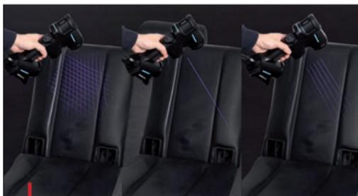
Les scanners 3D à main d'Hexagon disposent de 3 modes de mesure adaptés aux principaux types d'applications. Le mode standard utilise 22 lignes laser bleues et une seule ligne laser bleue pour couvrir de grandes surfaces. Le mode fin utilise 5 lignes laser bleues parallèles pour des données haute résolution sur des petites caractéristiques. Le mode linéaire utilise une seule ligne laser pour la numérisation de zones difficiles d'accès.
