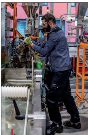
Le Plastics Applications Lab est équipé d'une extrudeuse de compoundage bi-vis corotative.
