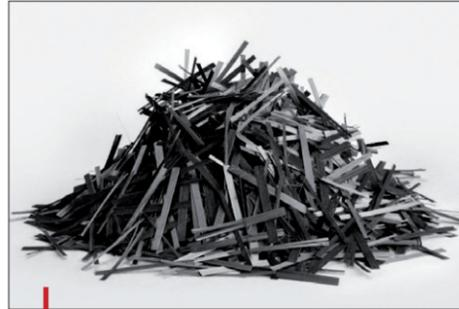
La technologie Fairmat permet de recycler les fibres de carbone de multiples fois.
