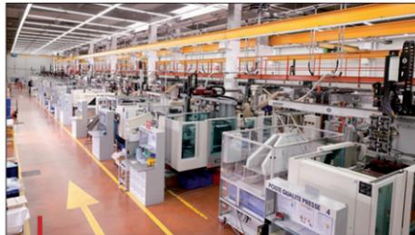
L'atelier d'injection dispose d'un parc de presses jusqu'à 550 t.
