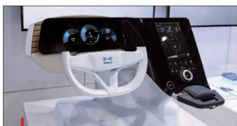
Pour fournir des informations au conducteur et/ou au passager, différents types d'écrans, leds et cadrans lumineux sont intégrés dans l'habitacle.
