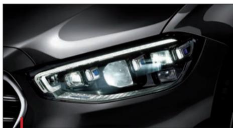
Marelli développe des modules d'éclairage multifonctionnels pouvant créer des systèmes lumineux complexes.
