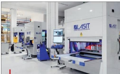
Ces machines permettent une élimination précise des points d'injection et bavures.
