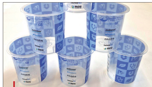
Avec une épaisseur de sa paroi de seulement 0,42 mm, ces pots en PET de 125 ml ne pèsent que 8,9 g.
