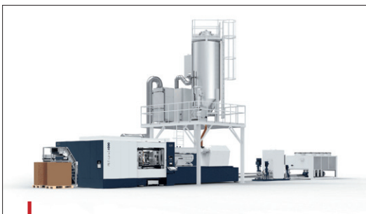
144 préformes légères (6,9 g) avec col 25/22 sont produites toutes les 4,8 secondes sur cette ligne PET-Line 4000.
