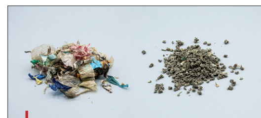
Le retraitement de déchets plastiques fortement contaminés (à gauche) permet de produire des agglomérats (à droite) ayant une densité apparente élevée.
