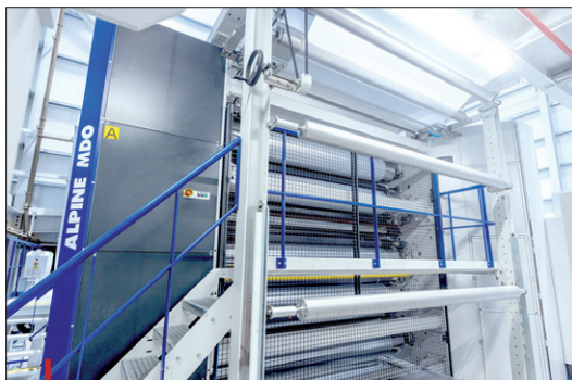
Ce module MDO est équipé de 12 cylindres d'étrépage.
