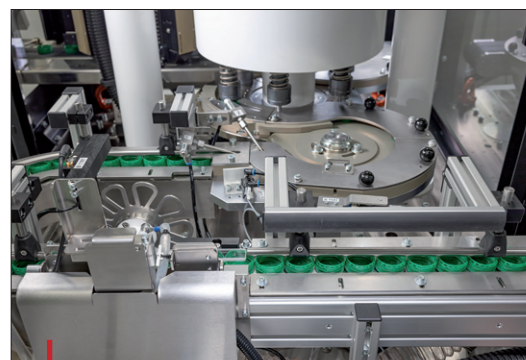
Les bouchons attachés ont généré la création d'équipements de refente spéciaux
