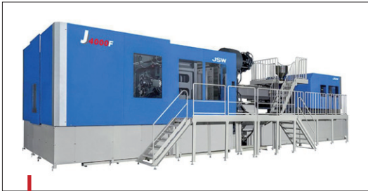
L'ergonomie de cette 4 000 t a été particulièrement soignée, notamment en termes d'accessibilité aux différents composants et d'espace occupé.
