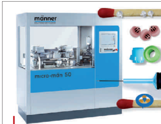
Outre ses gammes de canaux chauds, Männer a développé les cellules Micro-Män adaptées à l'injection automatisée à haute cadence de micro-pièces plastiques.
