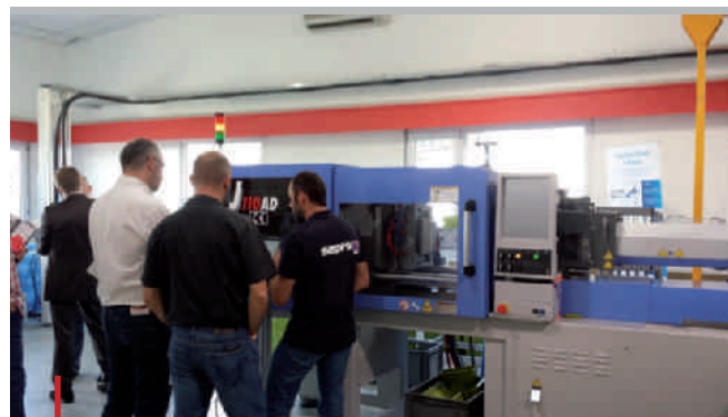
JSW propose la plus large gamme de presses tout-électrique, avec des modèles allant de 35 à 2 500 t de forces de fermeture.
