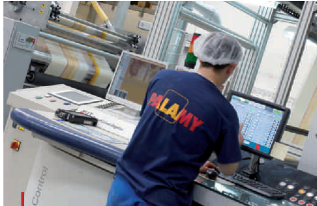
Les imprimeries du groupe sont équipées de systèmes de contrôle qualité sophistiqués, capables de détecter d'éventuels défauts sur une gaine défilant à haute vitesse.
