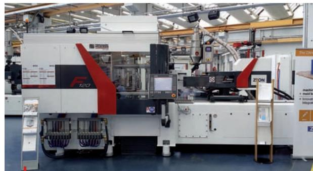
Cette presse F 120 conçue pour le médical était équipée d'un moule 4 empreintes et d'une cellule de chargement d'aiguilles pour produire des seringues jetables en COC.
