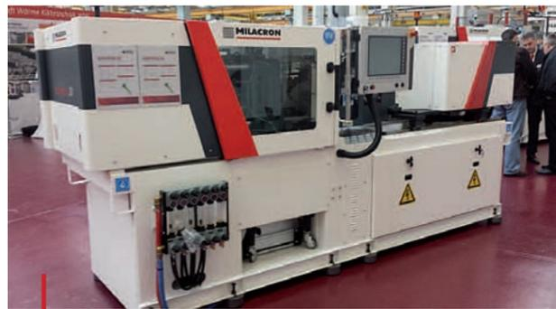
Lancé à la K 2013, ce modèle 30 t est le plus petit de la gamme de presses électriques Elektron.
