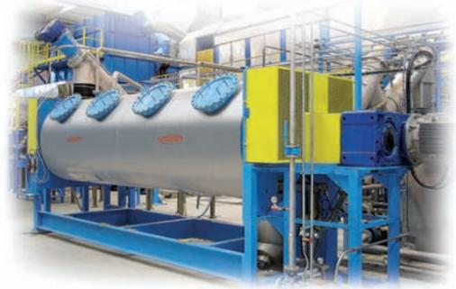
Ce système de lavage travaillant par friction en continu permet d'éliminer la majeure partie des polluants avant le lavage proprement dit des bouteilles ou paillettes de PET.
