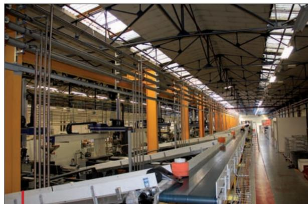
Utilisant des tubes sans soudure, le circuit d'alimentation en eau des moules et machines est facilement évolutif. Prestation 100 % Martiplast.
