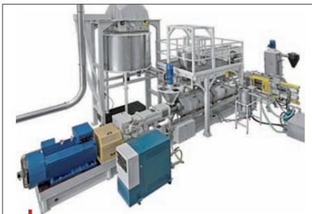
Les lignes de recyclage-compoundage Binova sont basées sur des extrudeuses bivi corotative à segments modulaires.
