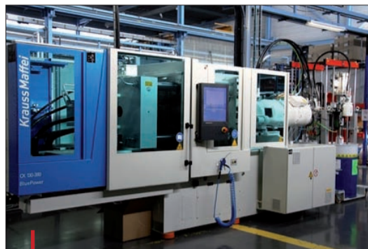
Presse hybride KraussMaffei CX 130-300 installée en décembre 2014 pour le moulage de LSR.
