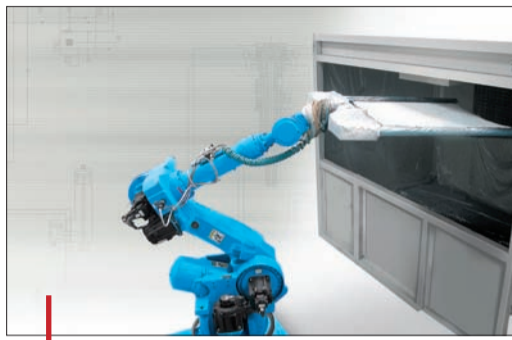
Le procédé de production du toit composite de la Smart fortwo bénéficie de l'expérience de Hennecke, acquise sur plus de 80 lignes de fabrication de pièces en PUR + nids d'abeille papier.
