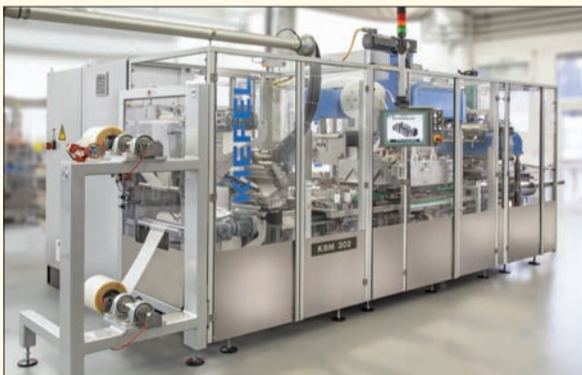
La ligne de soudage compacte KBM 302 peut produire de 1 000 à 2 500 poches/h selon la technologie de soudage utilisée.
