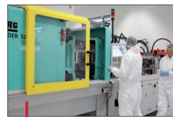
Presse à injecter les LSR dans un environnement ISO 7.
