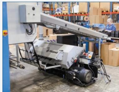
Le LBB 300 peut être équipé d'une tête de tirage synchronisée avec la machine de thermoformage.
