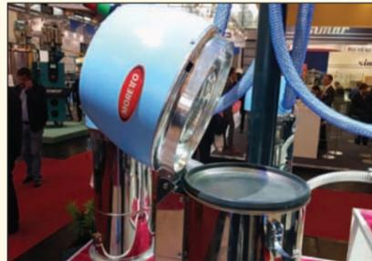
Les alimentateurs Kasko bénéficient d'une construction aluminium/inox extrêmement robuste.
