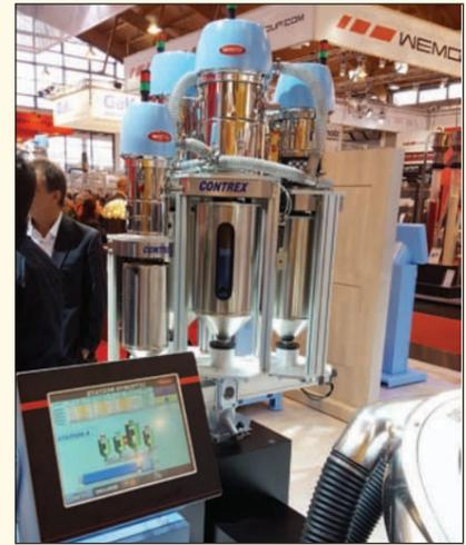
Station de dosage gravimétrique Gramixo et sa commande à écran tactile.
