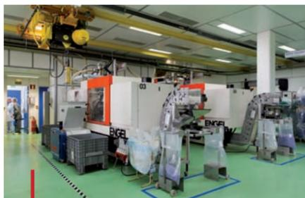
Cellule d'injection automatisée travaillant sous atmosphère contrôlée.
