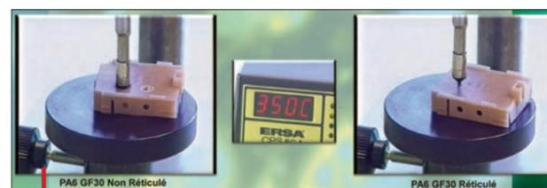
La réticulation par irradiation confère à certains polymères, PP et PA notamment, des propriétés de résistance thermique hors du commun. Après traitement, ce compound PA 6 PTS renforcé 30 % f.v. résiste ainsi l'enfoncement d'une pointe métallique portée à 350°C.
