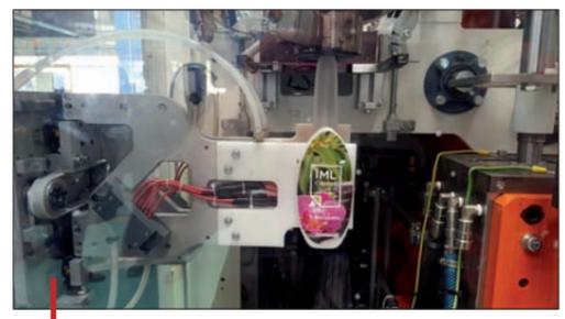
La démonstration portait sur la pose d'une étiquette IML par électrostatisme sur chaque face d'un flacon de shampoing.
