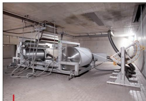
BGS dispose d'installations de traitement en continu dédiées à la radioréticulation des fils et câbles
