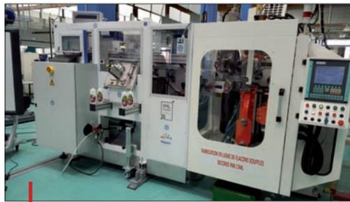
L'IML Center installé au Plasticampus d'Oyonnax dispose d'une machine d'extrusion-soufflage Jomar équipée d'un système de pose robotisé d'étiquettes IML Machines-Pagès
