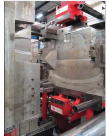
Un exemple d'application parmi d'autres : ce moule d'écran sous moteur exigeant 2 300 t de force de fermeture a pu être monté sans problème sur une presse de 1 800 t. Le retour sur investissement a été inférieur à 6 mois.
