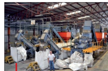
En sortie de tri, les bouteilles PET sont broyées par deux broyeurs Herbold ayant un débit de 1 800 kg/h chacun
