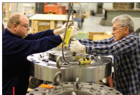
L'usine de Birmingham offre des prestations de réparation et nettoyage de filières d'extrusion-gonflage pour clients européens de Gloucester Engineering.
