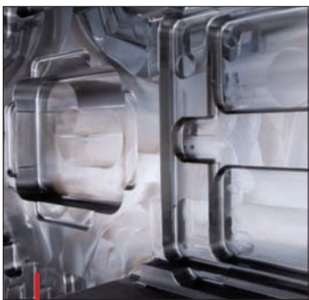
L'acier Formadur 400 est particulièrement adapté à l'usinage et au polissage ultra-précis de formes complexes.
