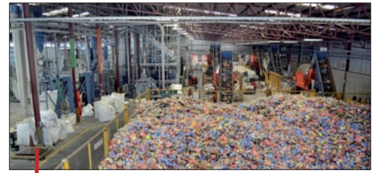
L'usine d'Invema recycle 2000 t/mois de bouteilles PET.
