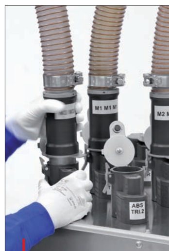
Le système MetroConnect de Motan équipé RFID facilite et sécurise l'alimentation matières des machines de production.
