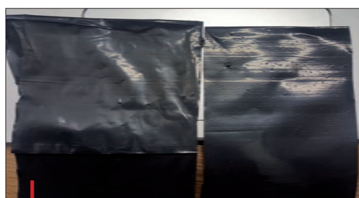
Film PEbd agricole recyclé, filtré avec un filtre percé au laser Fimic à 100 µm comparé avec un filtre concurrent.
