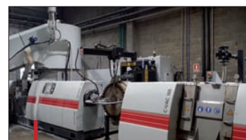
Cette ligne Starlinger est dotée d'un filtre Fimic RAS700 spécialement développé pour la société espagnole Anviplas.
