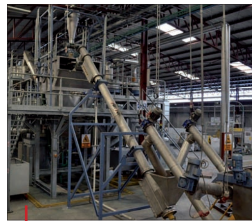
La fraction polyoléfine résultant du recyclage des bouteilles subit un nettoyage additionnel par un hydrocyclone également fourni par Herbold.
