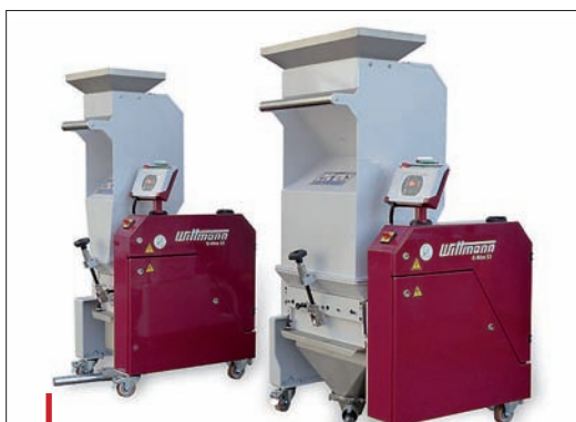
Les broyeurs G-Max sont dotés d'une console portable qui intègre de nombreuses fonctionnalités.
