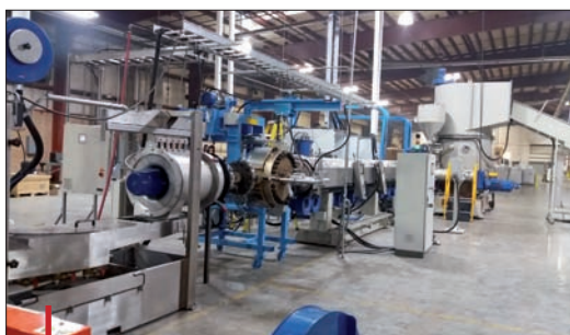
Ligne d'extrusion équipée avec un filtre automatique Fimic RAS600
