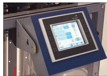
La table d'accouplement est équipée d'une commande reliée au système de gestion des matières.
