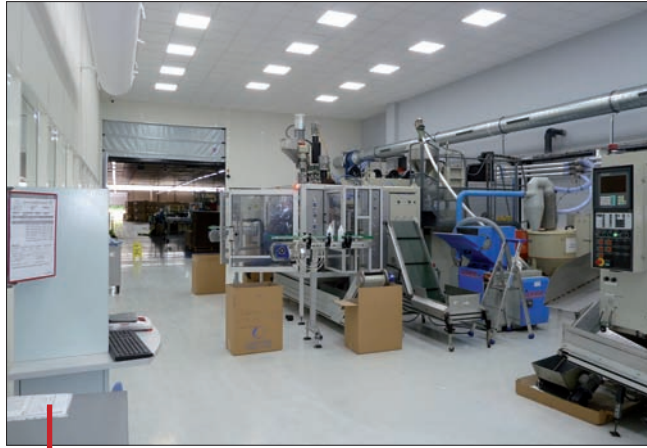
L'atelier produisant des bidons de 5 l est placé en liaison directe avec les quais d'expédition.
