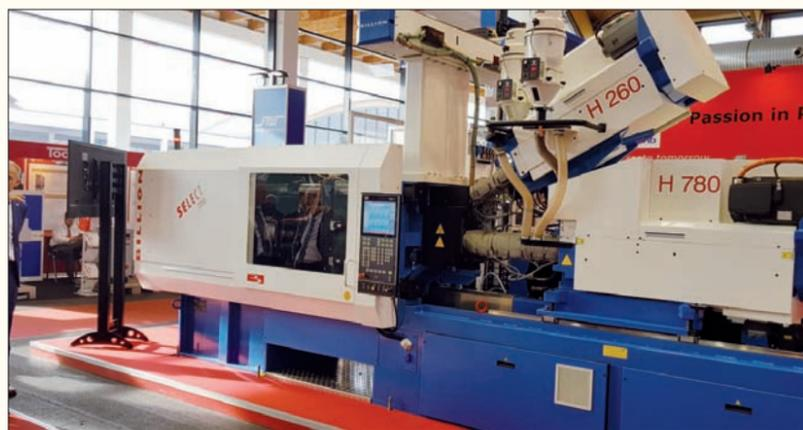
La presse 100 % électrique bi-matière 200 t Select H260/H780 fait partie d'une gamme de 40 à 600 t de force de fermeture.
