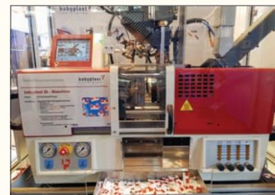
Presse Babyplast en configuration bi-matière 10/10PT 2K de 10 t de force de fermeture.
