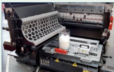
En configuration Duo, un broyeur à châssis bas LBB est installé en dessous d'un déchiqueteur Raptor.
