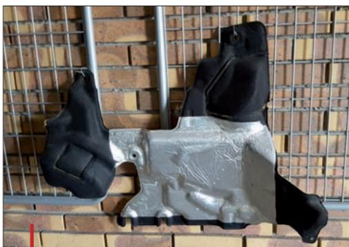
Pièce d'isolation thermique associant PU, textile et feuille d'aluminium.
