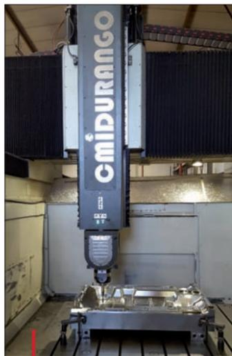
WorkNC peut piloter tous les centres d'usinage. Ici un centre Durango 5 axes.
