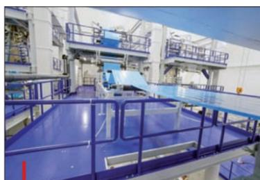
L'extrusion, l'enroulage et la découpe des films s'effectuent sous atmosphère contrôlée dans deux ateliers séparés.
