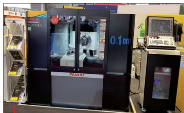
Dernier né de la division machines-outil, ce centre d'usinage et de gravure 5 axes par diamant Robonano offre une précision de 0,1 µm.
