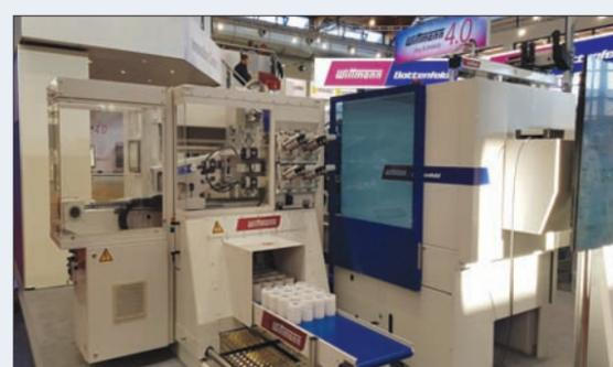
Cette presse EcoPower Xpress de 160 t était équipée d'un système IML mettant en oeuvre un robot latéral Wittmann
