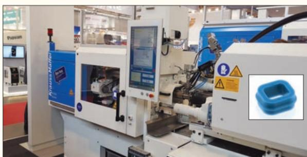
Cette presse PX 25-55 équipée SilcoSet mouleait des joints d'étanchéité à contre-dépouilles complexes.
