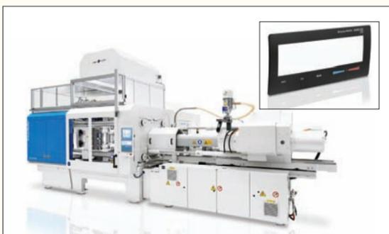
Ce pupitre de commande était produit sur une presse KM PX 320 selon un procédé mêlant double décor et étiquetage intégrés dans le moule.
