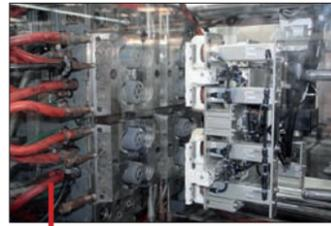
Les capuchons de protection de système d'amplification de force de freinage sont démontés par un robot.
