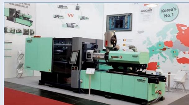
Dotée d'une vis de 45 mm x 20D, cette presse HD 220 A5 peut être équipée en option d'une unité d'injection électrique.
