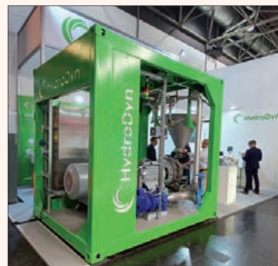
Les modules de lavage Hydrodyn consomment jusqu'à 50% d'énergie en moins qu'une installation conventionnelle.
