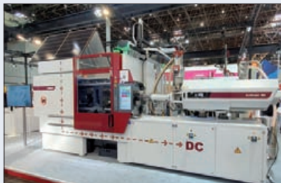
Cette EcoPower 180/750+ peut être alimentée directement par du courant continu généré par des panneaux solaires.
