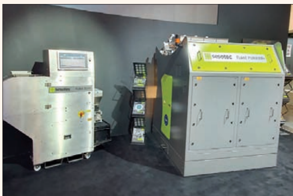
Les hautes technologies SESOTEC : analyse (Flake Scan) et tri multi-capteurs (Flake Purifier) de matériaux vierges et recyclés.
