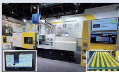
Cette Roboshot α-SiB de 220 t tirait parti des fonctionnalités logicielles de la commande CNC 31i B servies par un écran tactile au format double page.
