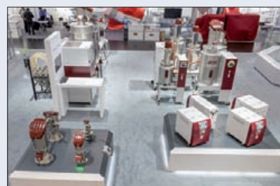
Wittmann exposait l'ensemble de ses gammes de périphériques : alimentation, séchage et dosage des matières, et thermorégulation des moules (gamme Temprom plus D, au premier plan à droite).
