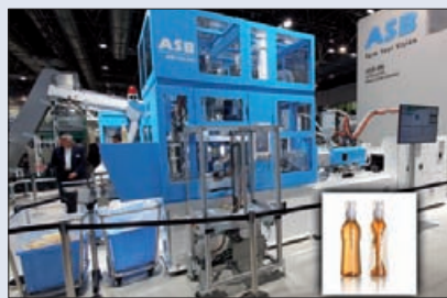
La configuration bi-matière facilite l'utilisation de recyclé en couche extérieure.
