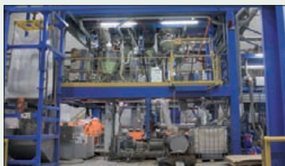
Cette ligne Leistritz réalise des greffages de PE et PP et des opérations de compoundage complexes.
