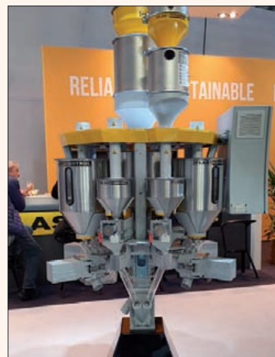
Les systèmes de dosage pondéral Plast-Control peuvent gérer jusqu'à 6 composants en plus de la matière principale.
