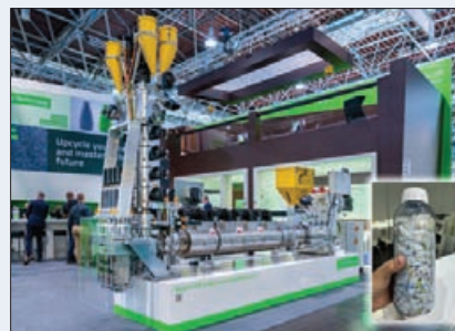
Cette unité W.Müller permet d'utiliser tous types de recyclé/rebroyé pour produire la couche centrale des flacons.
