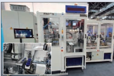
Cellule d'évacuation et conditionnement automatisé de pipettes médicales.
