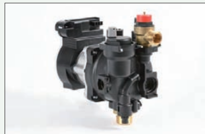
Cette pompe Wilo Para-MSL pour systèmes de chauffage est moulée en PA 6.6 Technyl® renforcé 30% fibres de verre, stabilisé à la chaleur et résistant au glycol. (Photo société Wilo SE)
