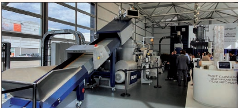
Cette ligne EREMA Intarema TVEplus recyclait 14 types de déchets plastiques différents durant toute la durée du salon.
