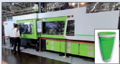
La position inclinée superposée de la seconde unité d'injection a permis de réduire la longueur de cette 240 t tri-injection.
