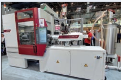
Cette SmartPlus 90/350 produisant un niveau à bulle était équipée du système de surveillance du conditionnement CMS Lite et d'une cellule d'automatisation conçue par le groupe.
