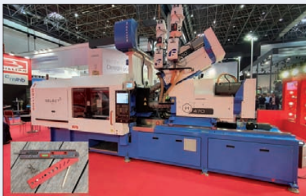
Cette presse Select 2 200 t servait de base à une cellule produisant une règle multifonctions composée de différents inserts surmoulés par un biopolymère et un PC/ABS recyclé.
