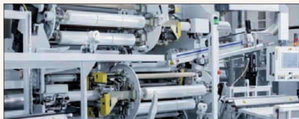
Le nouvel enrouleur à triple tourelle W4000-4S-3T accélère la vitesse de production de certains types de rouleaux de films étirables déroulables manuellement.
