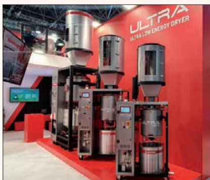
La gamme ULTRA Low Energy comprend 4 modèles offrant des capacités de séchage allant de 50 à 500 kg/h.
