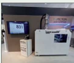
Grâce au soufflage hydride, il est possible de réduire l'éjection de granulés faiblement contaminés.
