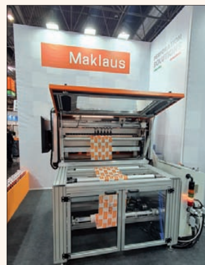
MAKLAUS a conçu un nouveau système de réglage des marteaux équipant ses macro-perforatrices de films.
