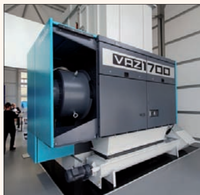
Le VAZ 1700 de Vecoplan est capable de broyer jusqu'à 25 t/h de déchets plastiques.
