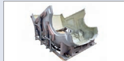
Les moules de formage, outils et gabarits de détourage sont produits sur des fraiseuses 5 axes de haute précision.
