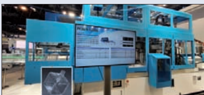
Cette machine de la gamme PF36 peut produire des bonbonnes d'eau carrée de 5 à 12 l.
