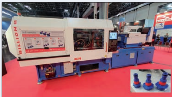
Ce nouveau modèle Select 2 150 t tout-électrique moulait un raccord de tuyau d'arrosage tri-matières. L'outillage mettait en œuvre la fonction de pilotage d'arbre rotatif Easyturn intégrée à la commande Dixit 4 pour opérer des changements automatiques de versions.
