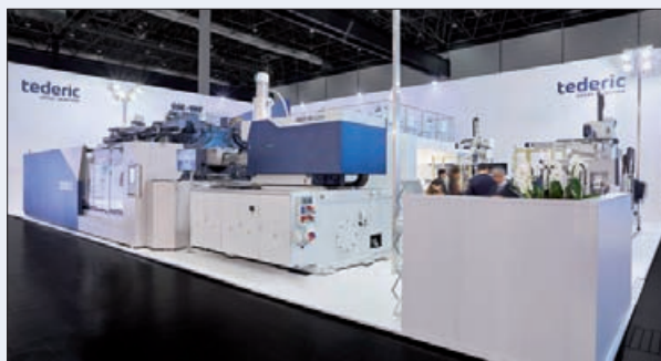
Cette presse de 1 120 t est équipée de deux unités d'injection électriques placées en opposition de chaque côté d'une zone de moulage centrale dotée d'une table rotative horizontale servo-commandée.
