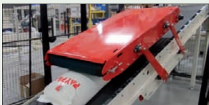
L'ensachage FFS automatisé réduit les opérations de conditionnement des granulés.
