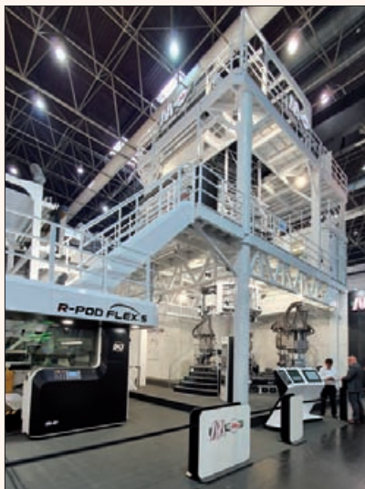
Les lignes de coextrusion 5 couches Macchi R-POD Flex offrent une grande flexibilité de production.
