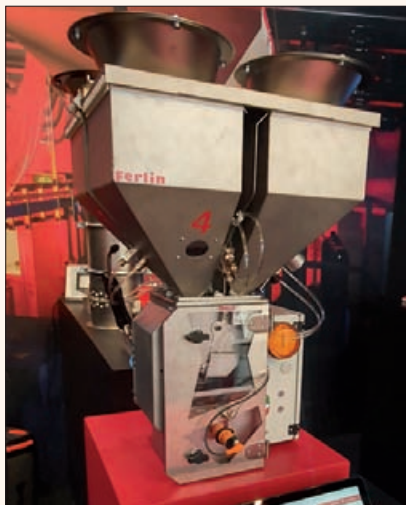
FERLIN a complété son offre par des doseurs adaptés aux dosages gravimétriques par lots jusqu'à 25 kg/h.
