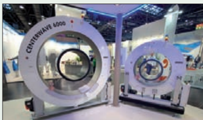
Les Centerwave 6000 peuvent mesurer des tubes ayant une épaisseur de paroi minimale de 1,6 mm.
