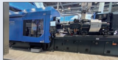
La PAC-E exposée injectait 2 100 bouchons d'eau minérale 26/22 en PEhd par minute sur un moule à 72 empreintes.
