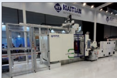
La gamme Jupiter propose des modèles servo-hydrauliques à 2 plateaux allant de 450 à 6 600 t.
